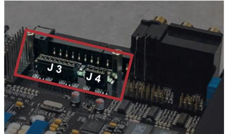
Um die Position eines Jumpers zu ändern, ziehen Sie diesen einfach nach oben hin ab und stecken ihn auf die gewünschte Position.
