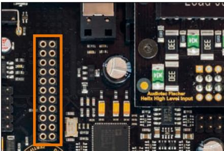
6. Achten Sie auf den richtigen Sitz des HEC Moduls und darauf, dass alle Kontaktstifte vollständig im Sockel stecken.
