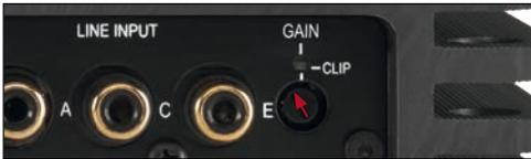
Es ist jedoch möglich, die Eingangsempfindlichkeit mit dem Regler 10 (*Gain*) und durch das Umstecken von Steckbrücken im Geräteinneren optimal an die Signalquelle anzupassen (siehe Seite 6, Punkt 4; Einstellung der Eingangsempfindlichkeit).
