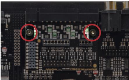
2. Ziehen Sie die Platine nach oben hin ab. Sie haben nun Zugriff auf die Jumper der Kanäle A bis F (J 3 & J 4).
