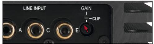
Es ist jedoch möglich, die Eingangsempfindlichkeit mit dem Regler 10 (*Gain*) und durch das Umstecken von Steckbrücken im Geräteinneren optimal an die Signalquelle anzupassen (siehe Seite 6, Punkt 4; Einstellung der Eingangsempfindlichkeit).
