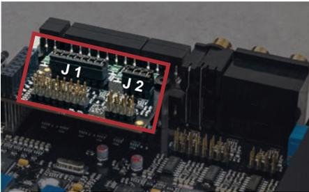
Die Jumper der Kanäle A bis F befinden sich unter der Highlevel-Erweiterungsplatine. Um Zugriff auf diese zu erhalten gehen Sie wie folgt vor:
